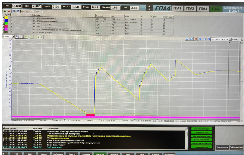
Рис. 3. Работа системы регулирования антипомпажного клапана с электроприводом «РэмТЭК» на различных режимах работы газоперекачивающего агрегата
